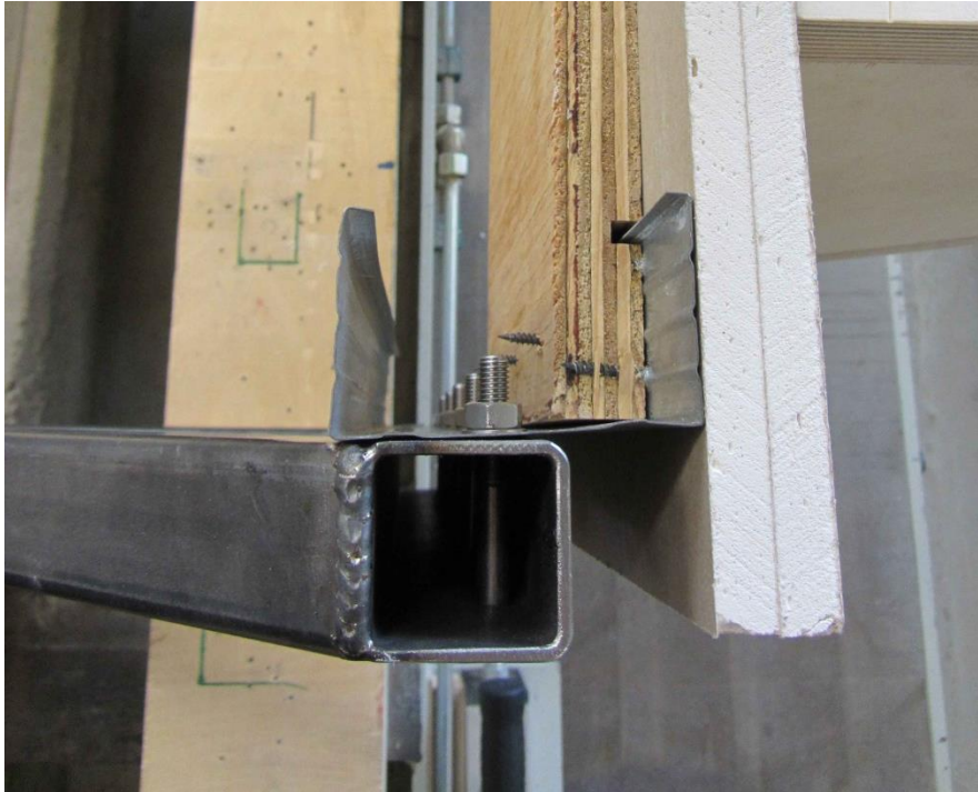
Abbildung 6 - Exemplarischer Prüfaufbau - Nut/CW-Profil
